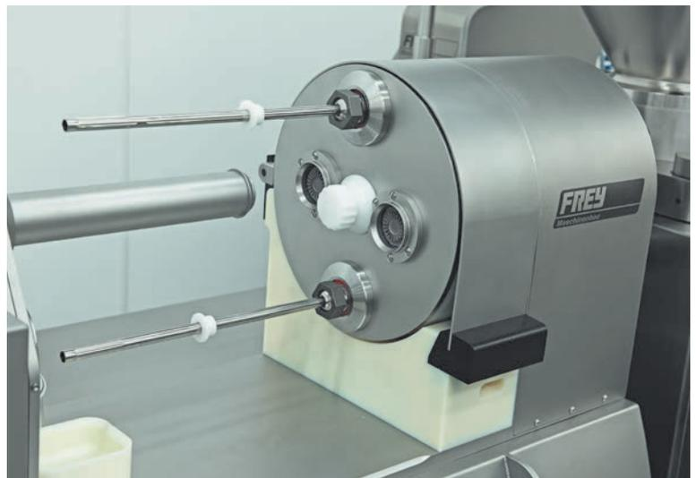
*Für eine exakte Positionierung der Portionierriemen und für das Abdrehen kommt je ein präziser und dynamischer Servomotor zum Einsatz.*
